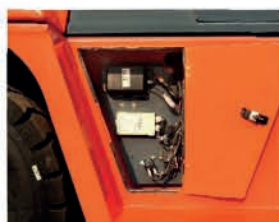
Compartimento separado para el sistema eléctrico
